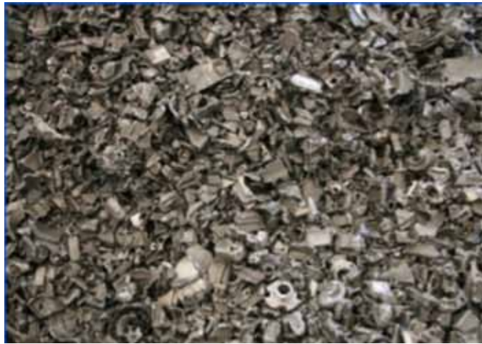
Rottame pretrattato con tecnologia a catena
